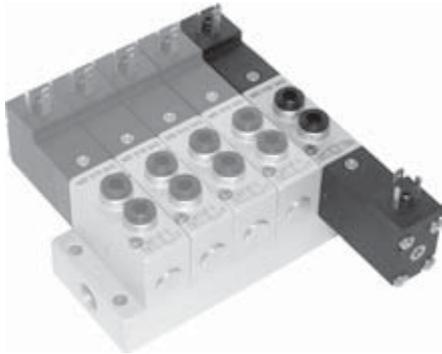
5/3-Wege Magnetventil, federzentriert. Anschlüsse 2 und 4 im Ventil, Anschlüsse 1, 3 und 5 sind in der Grundplatte.
