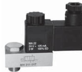
Direkt gesteuertes 3/2-Wege Magnetventil normal geschlossen mit mechanischer Federrückstellung. Anschluss 2 ist als Hohlschraube gestaltet.
