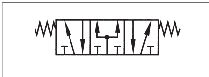
5/2-Wege-Ventil, Mittelstellung belüftet
